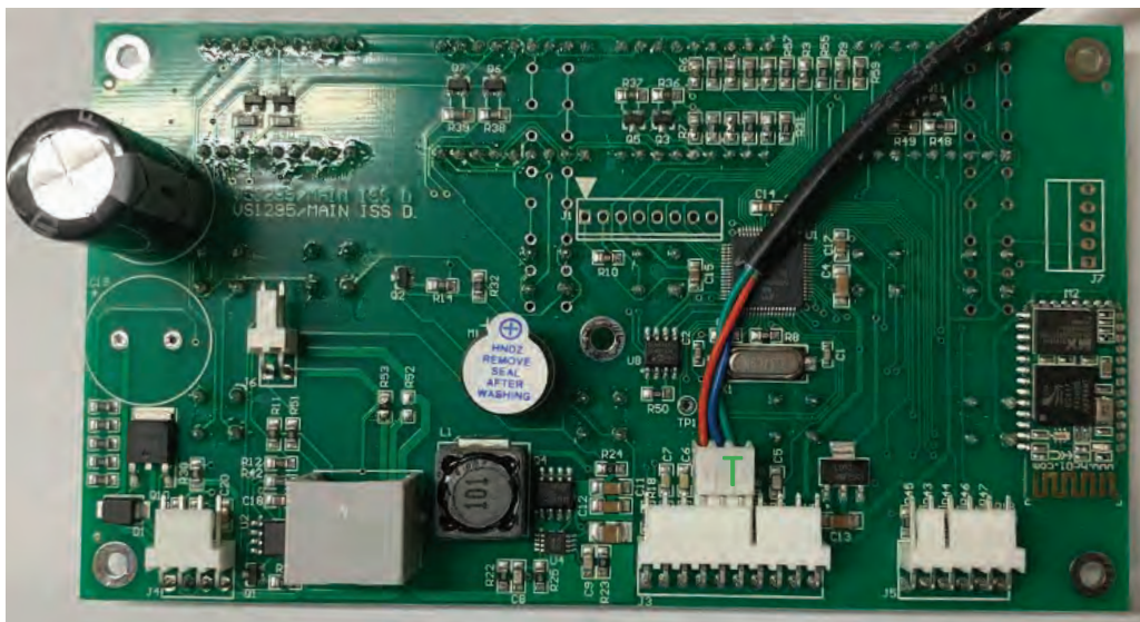
T Tachometer Pins 4,5,6
